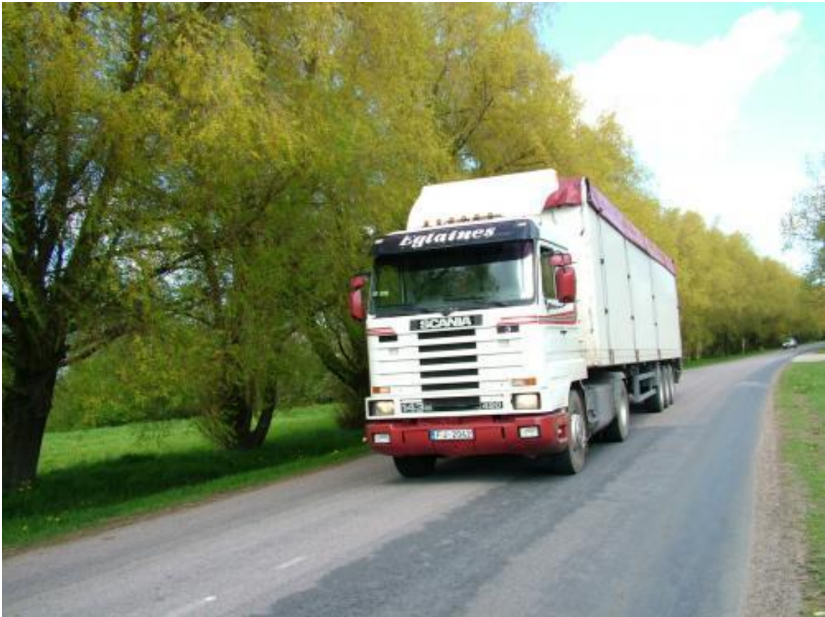
2. attēls. Kūdras transportēšanas automašīnas piemērs: ietilpība ~90 m 3 , 5 asis, pilna masa 44 t.
