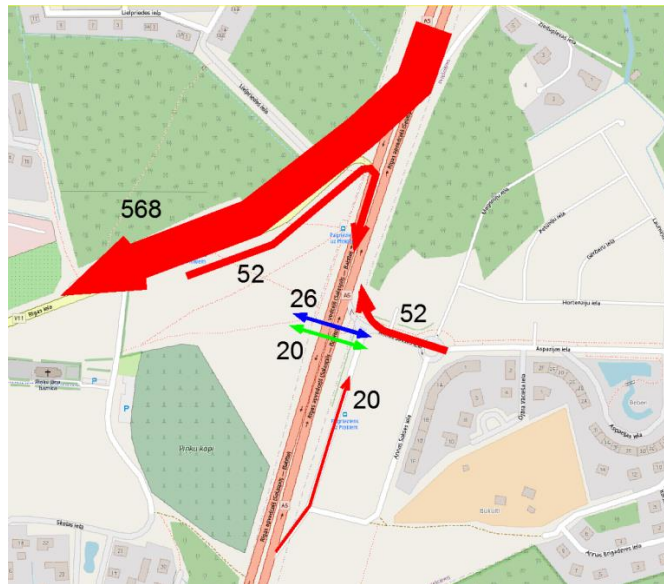
2.1.attēls. Vakara maksimumstundas intensitātes autoceļa A5 Rīgas apvedceļš (Salaspils – Babīte) Piņķu mezglā
