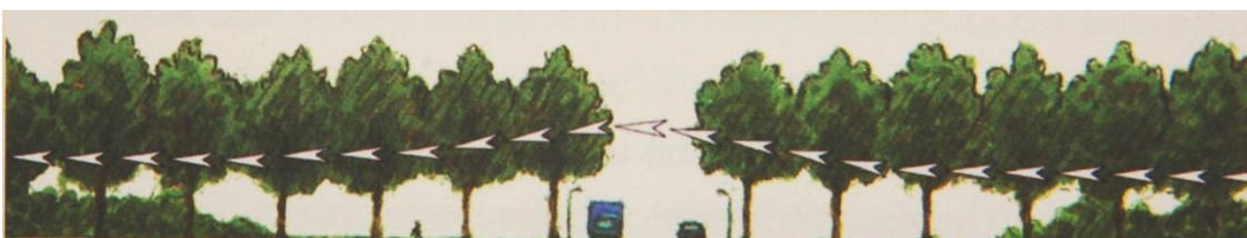
4.6. attēls. Risinājums, kā novirzīt sikspārņu pārvietošanos augstāk – koku vainagu līmenī jeb vismaz 6 m augstumā, ja konkrētajā vietā nav iespējama blīvas krūmu veģetācijas vai aizsargsienu izveidošana pašā autoceļa malā: sikspārņu pārvietošanos aizsargsienas vietā ietekmē uzstādītais apgaismojums (attēls no bukleta “Bats and Road Construction”, Nīderlande)
