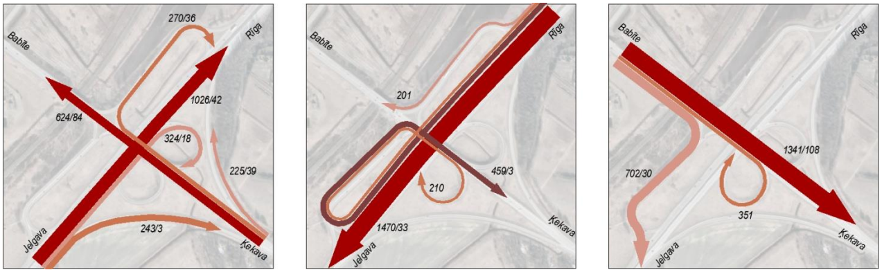
2.5.attēlu grupa. Vakara maksimumstundas intensitātes autoceļu A5/A8 mezglā (aiz slīpsvītras – kravas automašīnas)
