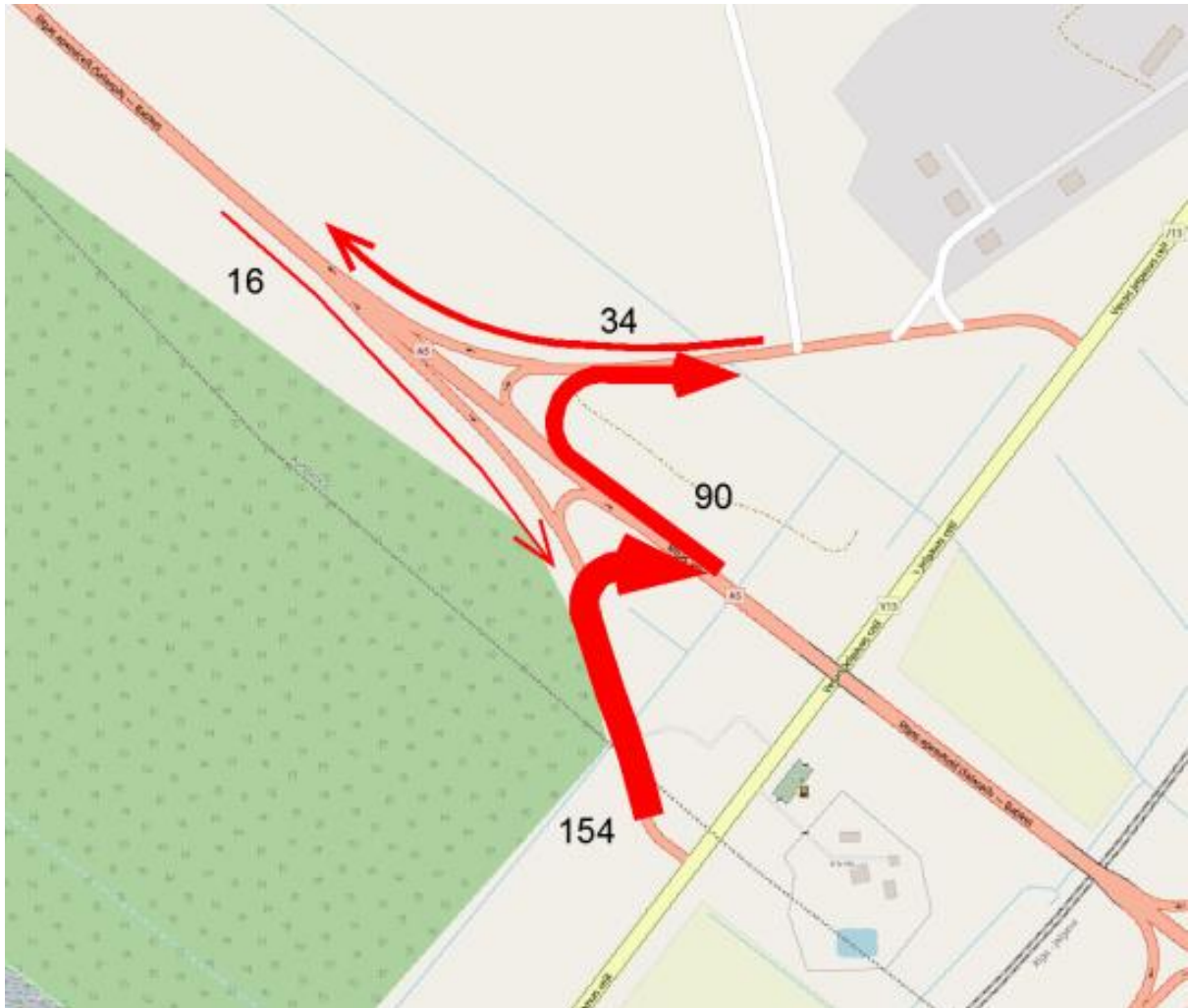
2.4.attēls. Vakara maksimumstundas intensitātes autoceļa A5 Rīgas apvedceļš (Salaspils – Babīte) un V13 Tīraine – Jaunolaine mezglā
