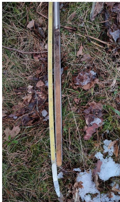
Augsnes slāņi – ~ 0,1 m auglīga augsne, ~ 0,35 m smilts
