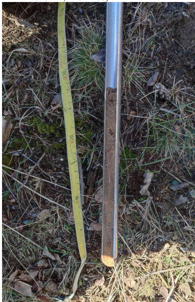
Augsnes slāņi – ~ 0,04 m auglīga augsne, ~ 0,24 m smilts
